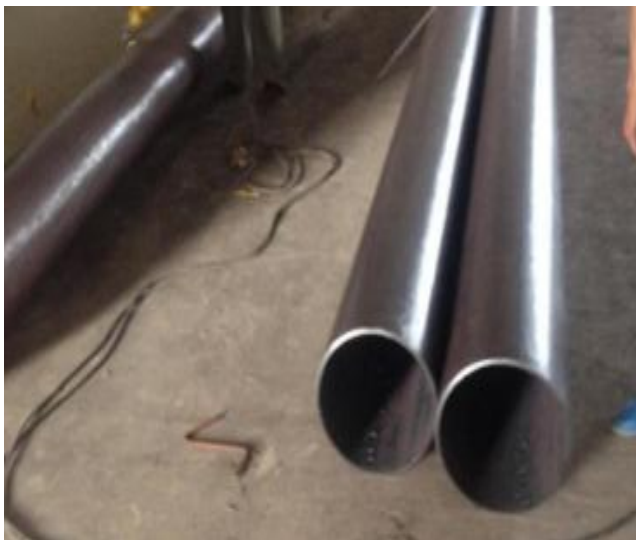
管道除锈实例图
