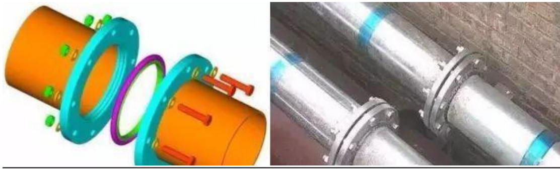
管道法兰连接
